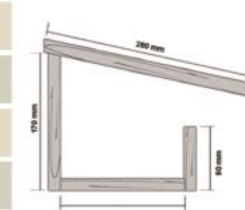
Plans nichoir semi ouvert les dimensions sont données pour des planches de 20 mm d'épaisseur
